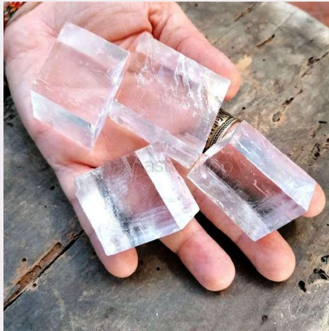
La calcite è un cristallo **birifrangente**, ossia in grado di scomposizione di un raggio di luce in due raggi.
